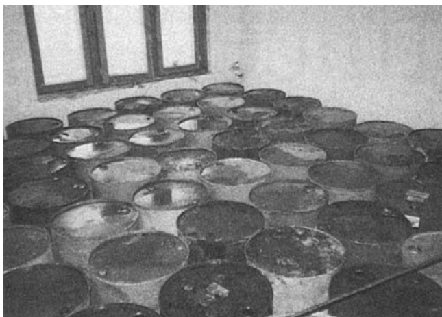
Rys. 1. Beczki z wodą jako obciążenie próbne
